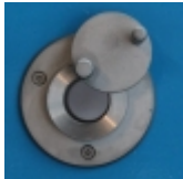
Wziernik montowany w drzwiach pieca o średnicy 20 mm
